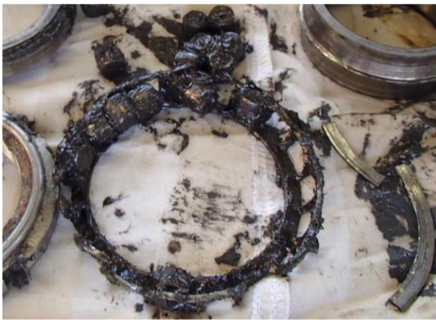
Hình 10 Dạng sóng AE, phổ và hình dầu mỡ thang cuốn không tốt
