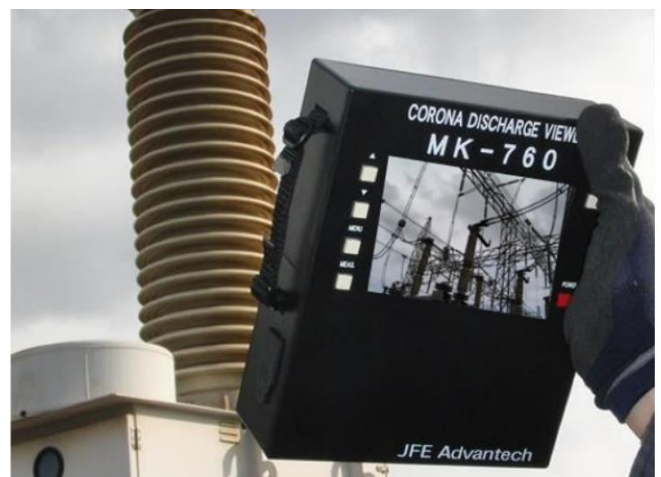
Hình 4 Sử dụng MK-760 tại một trạm biến áp để tìm kiếm hiện tượng phóng điện cục bộ
