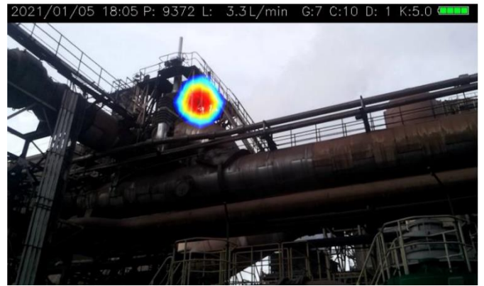
Hình 16 Máy MK-750ST phát hiện rò rỉ đường ống gas ở nơi cao ngoài tầm với
