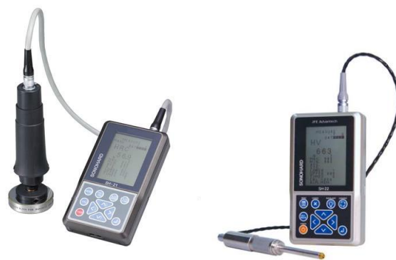
Hình 4 Ngoại hình máy đo độ cứng siêu âm cầm tay SH-21 (bên trái) và SH-22 (bên phải)
