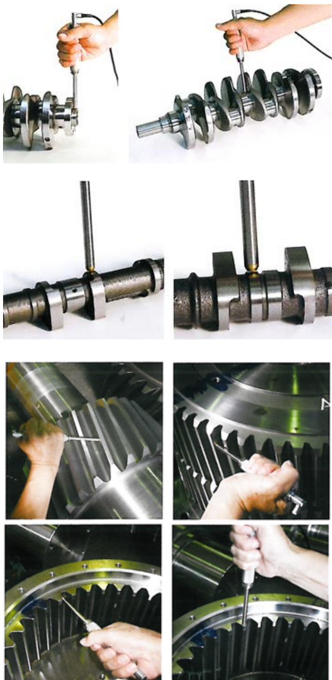
Hình 7 Đo độ cứng bộ phận xe ô tô
