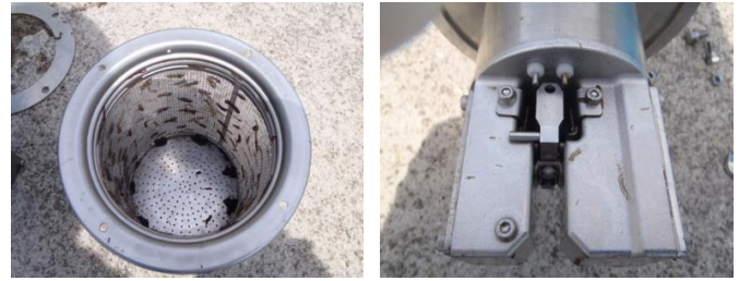
Hình 13 Vỏ bảo vệ đầu đo và cảm biến sau 11 tháng không cần bảo trì
