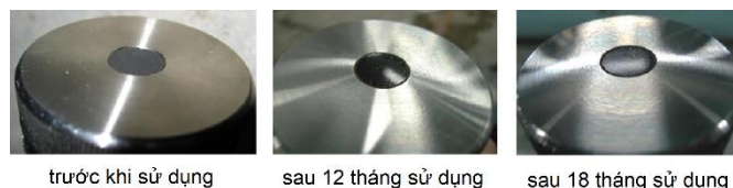
Hình 16 Cảm biến không bị hư hỏng vật lý sau khi sử dụng liên tục trong thời gian lâu dài.
