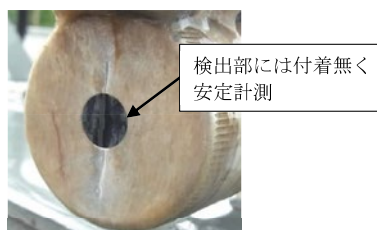
写真-5 検出部の付着状況(約45日経過後)
