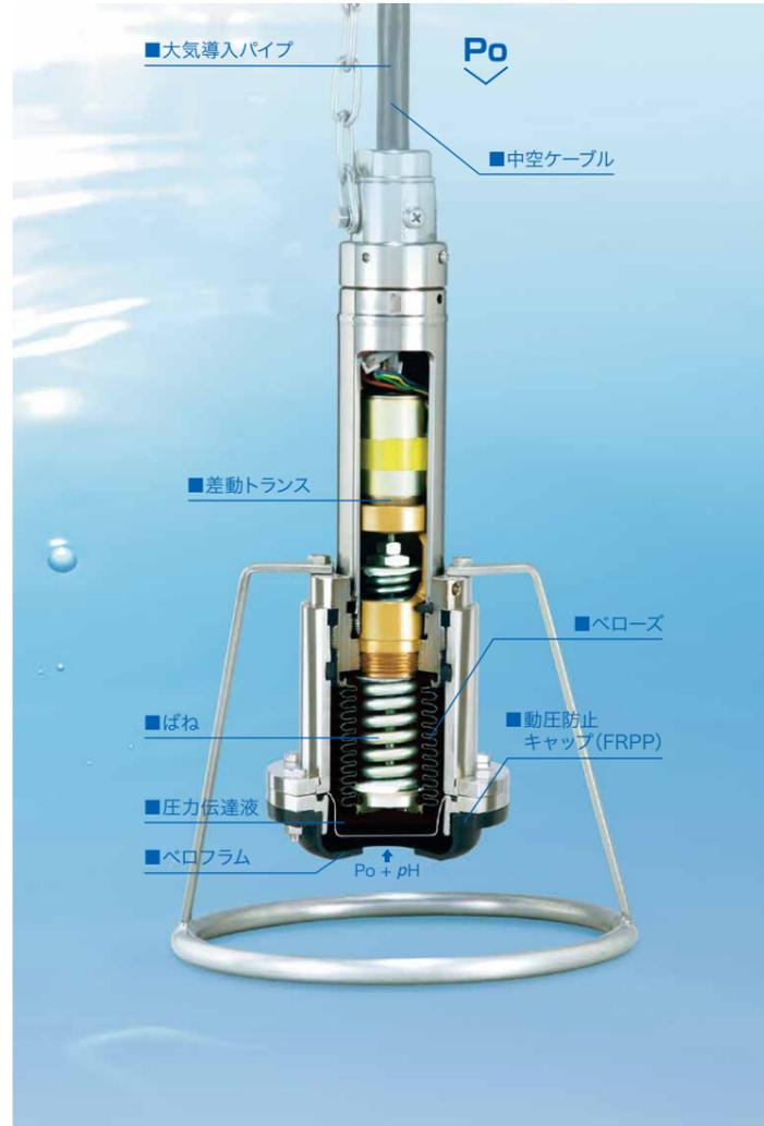
水頭圧がベローズにかかると、その圧力に応じてベローズとばねが圧縮変化し、その復元力で一定変位の位置で平衡します。そのときのベローズの変化を差動トランスにより、電気信号に変換して伝送します。
