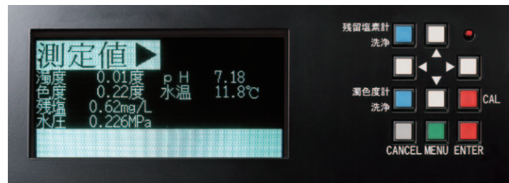
【変換器表示画面の一例と操作キー】
