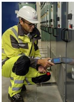
PD SCANはTEV（過渡接地電圧）センサーや超音波マイクを内蔵した小型、軽量の携帯型部分放電検出装置です。内蔵のTEVセンサーは、閉塞配電盤の扉を開けることなく、絶縁劣化の初期兆候である「部分放電」をすばやく検出できます。オプションのHFCT（高周波変流器）センサーを用いればケーブルの診断ができ、パラボラレーシーバー（超音波マイク）を用いれば、遠距離の部分放電を検出する事が可能になります。
