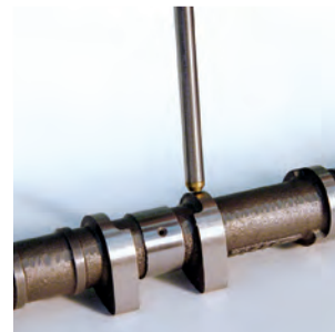
カムシャフトの端面部計測例
