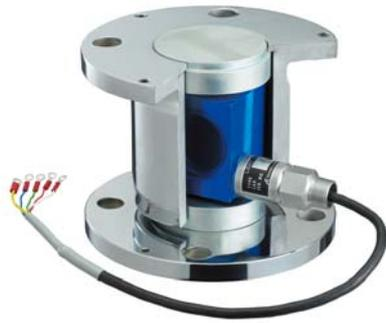
ロードセル式ホツパ重量計は、各種のホツパ・タンクを自動調芯型ロードセルで支持して内容物の重量を測定し、上下限の警報・供給、排出の制御を行うものです。振れ止め(タスキ・チェックロッド)に斬新なアイデアによるロードセル取付金具一体型を採用することにより取付工事を容易にしています。より精度の高い計量制御を行うホツパスケールとしてもご使用いただけます。
