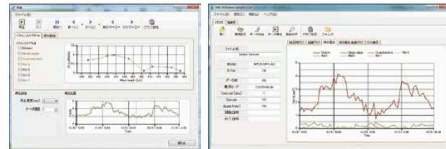
測定データ画面 励起スペクトル(上)とクロロフィル蛍光の時系列(下)
