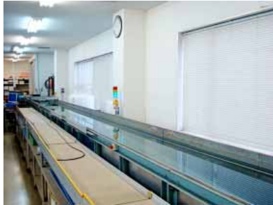
流速検定台車水槽
