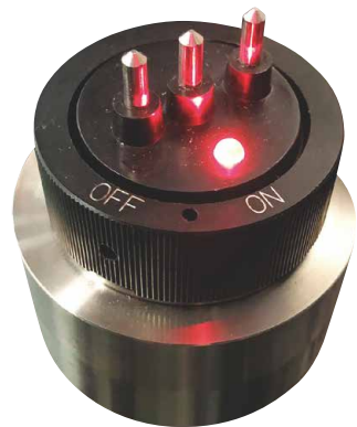
電源スイッチ部
