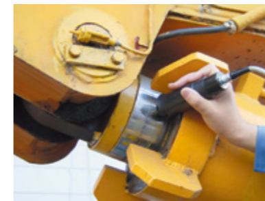
● 硬さ測定による経年変化の診断
