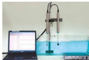
実験室用電磁流速計
