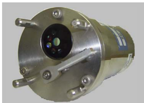
図 3 開発した藍藻蛍光光度計( Cyanosens )。
