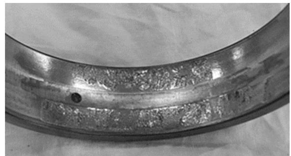
図 10 AE 測定後に取り外した軸受の損傷状況
